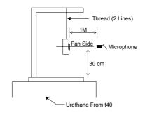
1 METER FROM MICROPHONE TO FAN INTAKE
